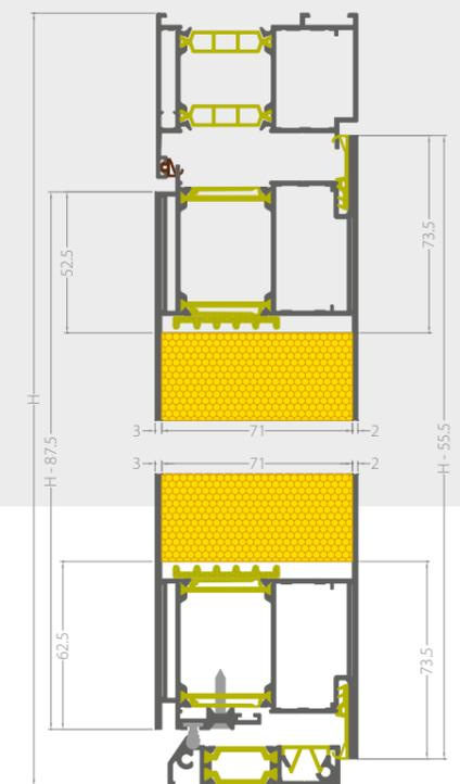
Querschnitt des Türrahmens mit einer Stärke von 75 mm.
