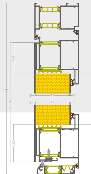
Querschnitt des Türrahmens mit einer Stärke von 75 mm.
